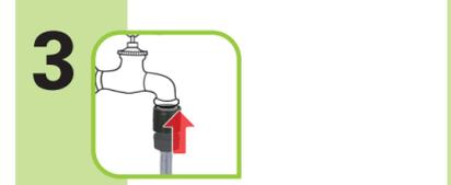
**3** Schlauch an Wasserzulauf anschliessen
