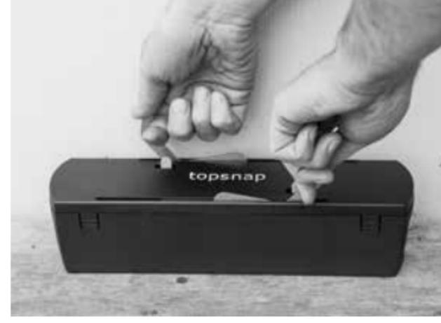
2. Spannhebel immer von Hand in die Ausgangsposition zurückführen.
