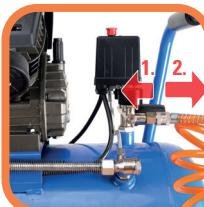
**Schlauch sicher entfernen: Ring nach hinten ziehen**
