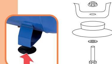
Gummischutz am Stützfuss einsetzen
