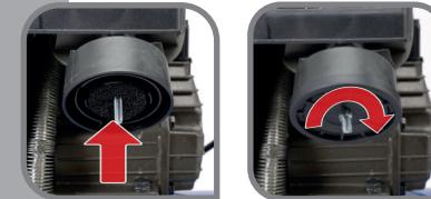
Ansaugfilter einsetzen, Abdeckung anschrauben (beidseitig)
