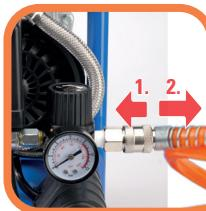
**Schlauch sicher entfernen: Ring nach hinten ziehen**
