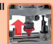
Passenden Fräser vollständig einsetzen
