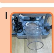
Bei Bedarf: Adapter für Staubsauger aufsetzen
