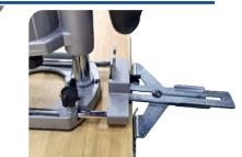
Feststellschraube für seitliche Führung
