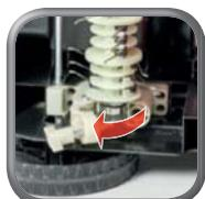
Schraube lösen, Abdeckung ausklappen
