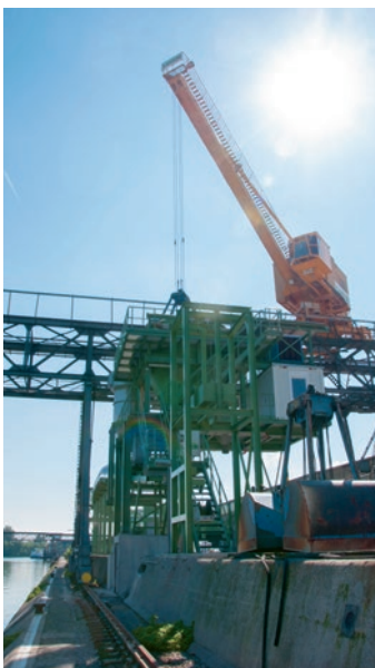
Der lose Dünger wird vom Schiff mittels Kran abgeladen.
