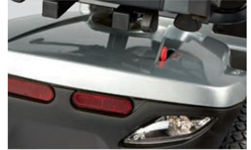
Blinker, Licht und Rückstrahler sorgen für eine gute Sichtbarkeit.
