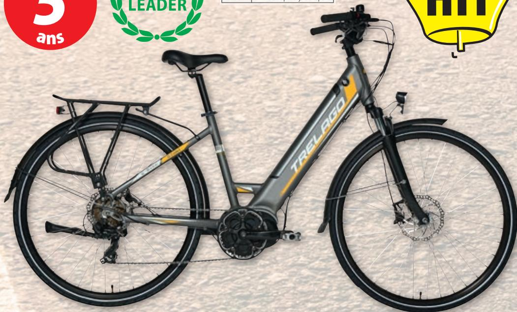
Freins à disque hydraulique
