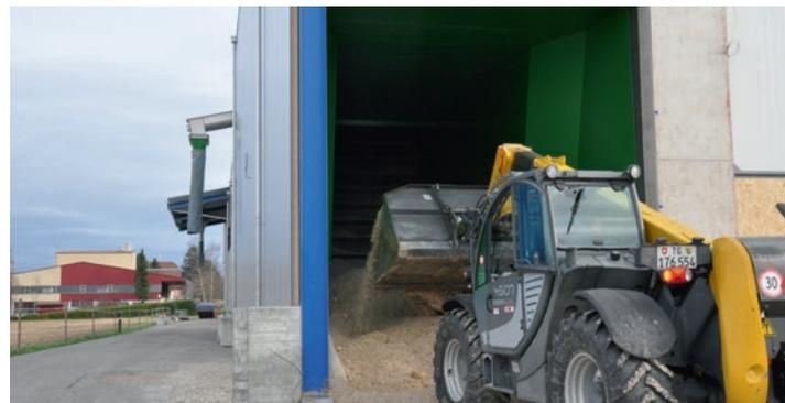
**Mit dem Teleskoplader werden die Zuckerrübenschnitzel ins Gebäude befördert.**
