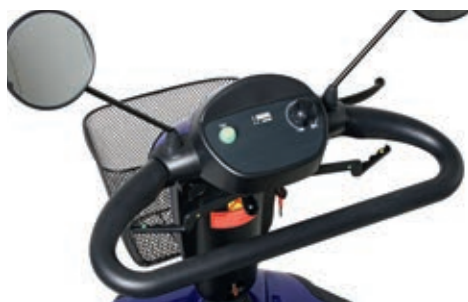
Commande facile à basculer et bouton de réglage de vitesse en continu.
