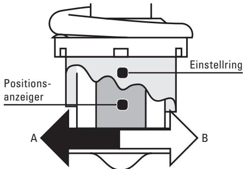
Drehen Sie den Einstellring nach links (A), um die Federvorspannung zu erhöhen (harte Federung). Um die Federvorspannung zu verringern (weiche Federung), drehen Sie den Einstellring nach rechts (B). Richten Sie die Kerbe im Einstellring an der Gegenmarkierung am Stoßdämpfer aus.
