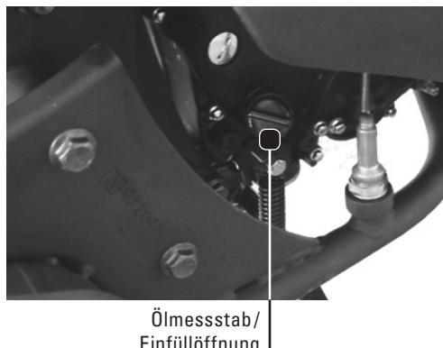
Der Ölstand darf nicht unter der unteren Markierung oder über der oberen Markierung liegen. Wenn der Ölstand zu niedrig ist, füllen Sie 4-Takt-Motorenöl nach.
