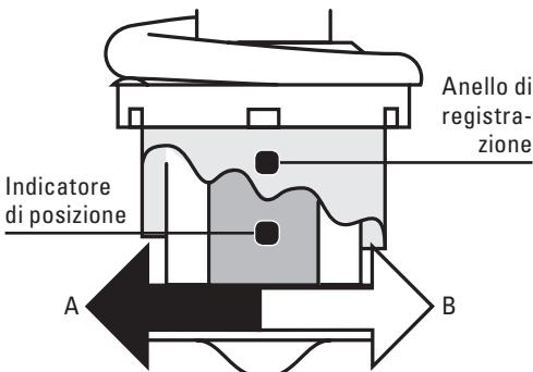
Ruotate l'anello di registrazione verso sinistra (A) per aumentare il pretensionamento della molla (ammortizzatore duro). Per ridurre il pretensionamento della molla (ammortizzatore morbido) ruotate l'anello di registrazione verso destra (B). Orientate gli intagli dell'anello di registrazione verso la tacca di riscontro del paraurti.
