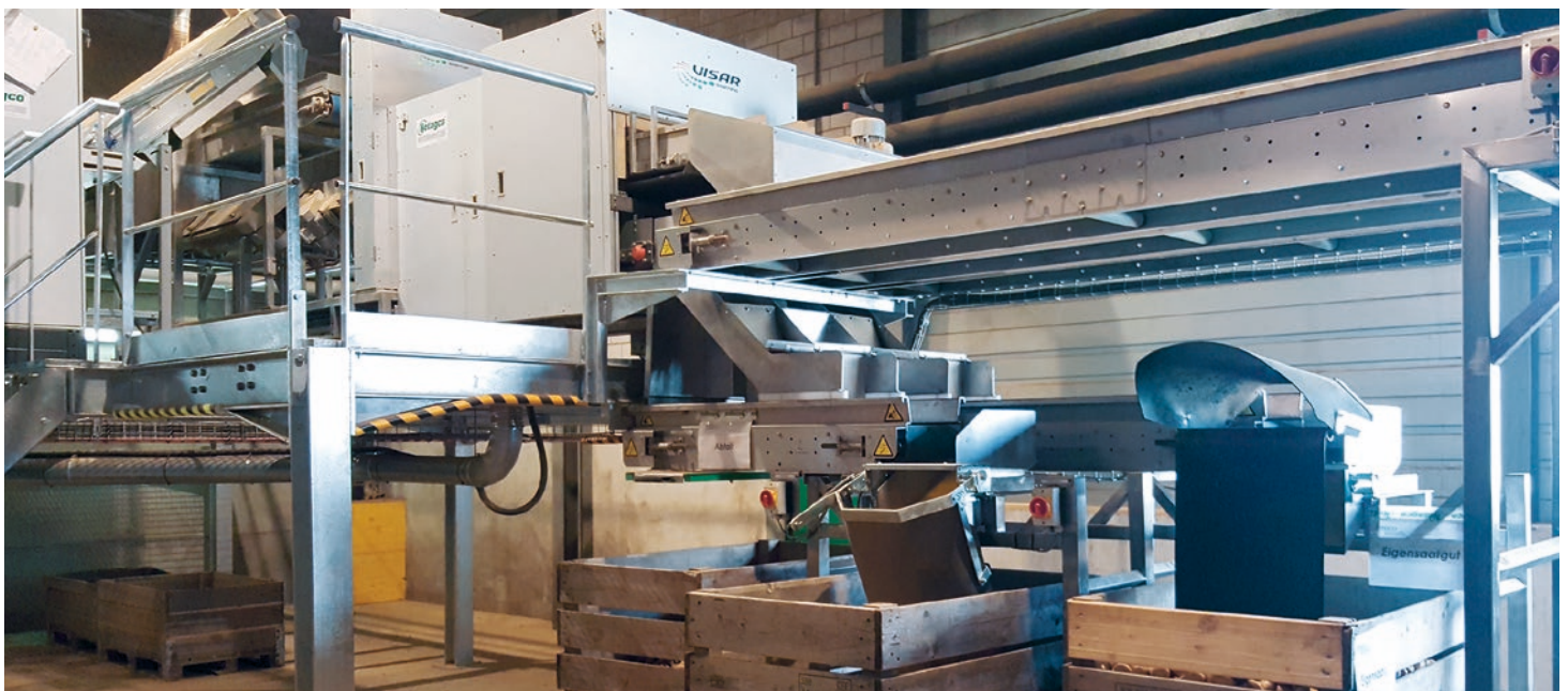
Mit der modernen Anlage können bis 120 000 Kartoffeln pro Stunde sortiert und kalibriert werden.
