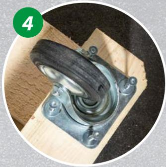
4 Befestigen Sie die Lenkrolle jeweils mit je 4 Spanplattenschrauben kurz und Karosseriescheiben.
