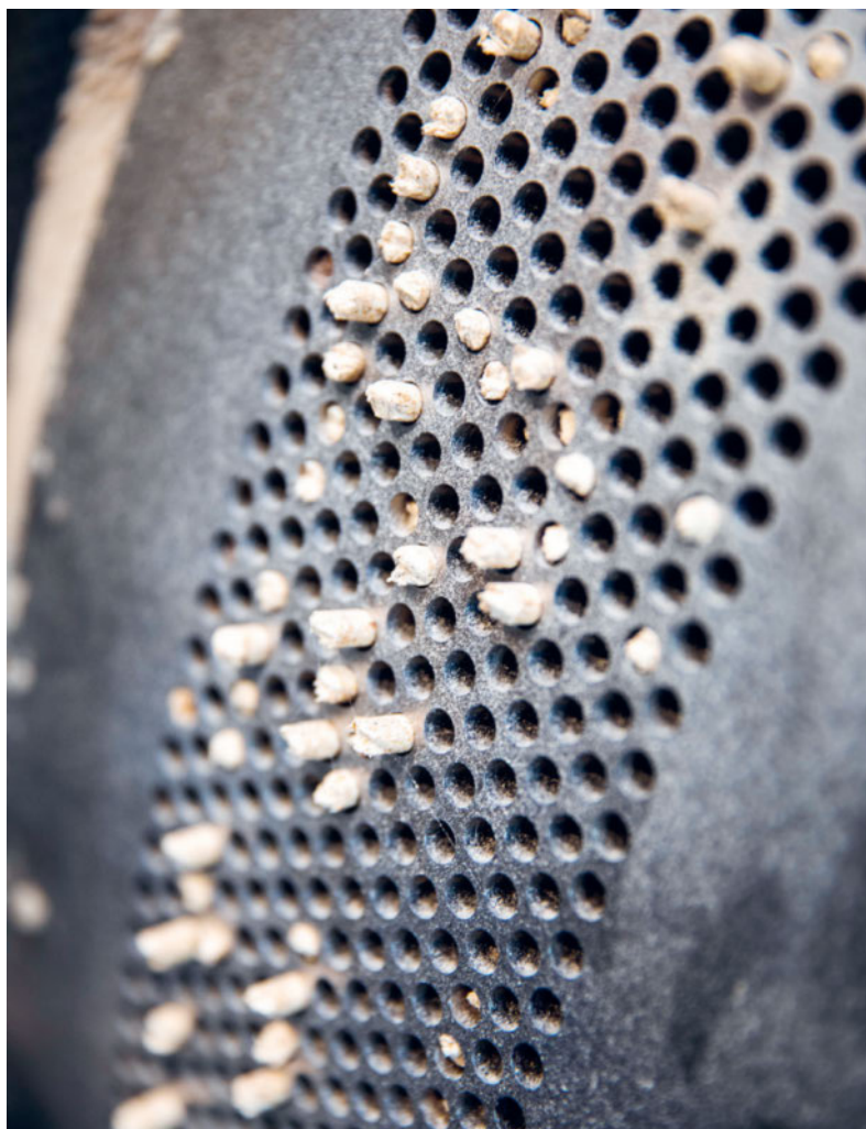
Le bois broyé est poussé sous haute pression dans les trous d'une matrice.
